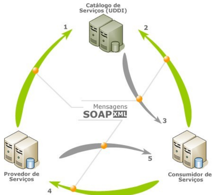
Figura 3 – Visão geral do funcionamento de Web Services :
